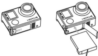
4. Cargue la batería conectando la cámara a la computadora o a otro adaptador de carga USB utilizando el cable USB incluido. La luz roja indicadora de estado de la cámara se enciende durante la carga y se apaga cuando finaliza.
