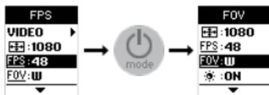
4. Presione el botón **Shutter/Select** [
